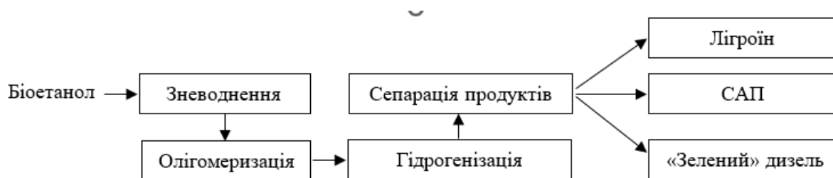
Рисунок 1. Блок-схема отримання авіаційного біопалива ATJ-SPK з біоетанолу [10].
