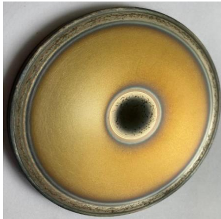
ნახ.4 ნაწილობრივ გაფრქვეული Zr (99.999%) სამიზნე. დიამეტრი 100 მმ, სისქე 6 მმ
