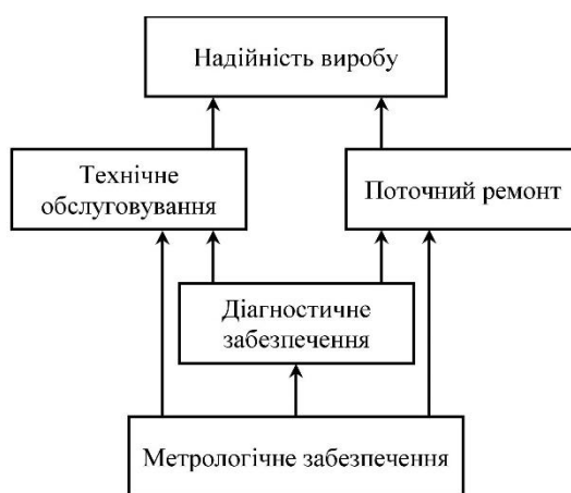
Рис.1. Взаємозв'язок метрологічного та діагностичного забезпечення з показниками якості технічного обслуговування і поточного ремонту РЕЗ.
