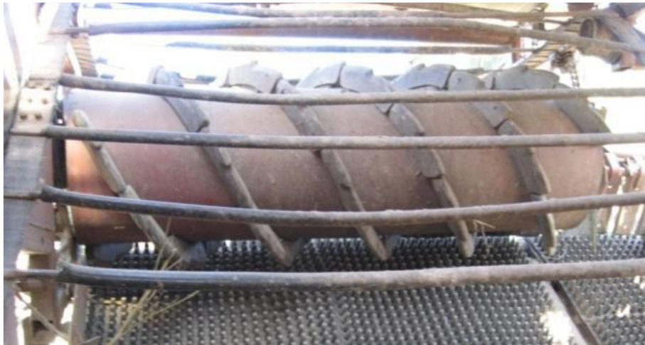
Рис. 8. Загальний вигляд органу вторинної сепарації картоплебирального комбайна КПК-2-01.
