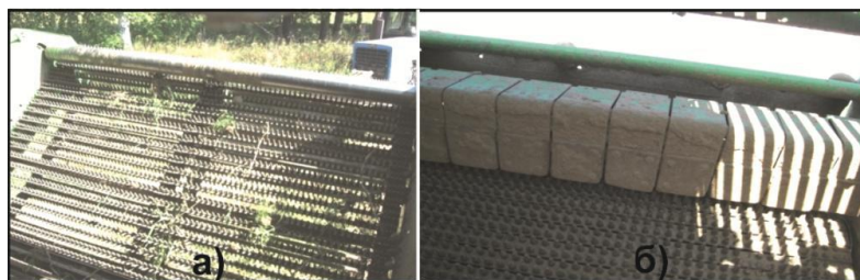
Рис. 5. Загальний вигляд органів вторинної сепарації картоплезбирального комбайна AVR-220В:
