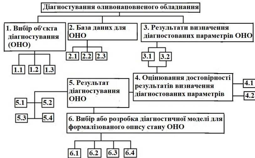
Рис. 2. Принципова схема процесу діагностування ОНО АЕС за результатами контролю властивостей проб ТС: 1.1 – вибір діагностичного забезпечення; 1.2 – вибір засобів діагностування ОНО; 1.3 – вибір алгоритму діагностування ОНО; 2.1 – технічний стан ОНО; 2.2 – місце відбору проб ТС із ОНО; 2.3 – нормативні показники: якості для ТС; діагностованих параметрів для ОНО; 3.1 – відповідність встановленим нормам для ТС та ОНО; 3.2 – невідповідність встановленим нормам для ТС та ОНО; 4.1 – ступень об'єктивної відповідності діагнозу дійсному технічному стану ОНО; 4.2 – ступень об'єктивної відповідності результату прогнозування технічному стану ОНО; 5.1 – результат визначення виду стану ТС в ОНО та стану ОНО; 5.2 – результат визначення можливих причин зміну стану ТС в ОНО та стану ОНО; 5.3 – результат прогнозування стану ТС в ОНО та стану ОНО; 5.4 – висновок про результат діагностування ОНО; 6.1 – аналітичний опис стану ОНО; 6.2 – табличний опис стану ОНО; 6.3 – графічний опис стану ОНО; 6.4 – інші форми опису стану ОНО.
