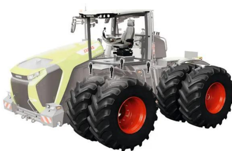
Рис. 14. XERION – унікальна концепція підвіски.
