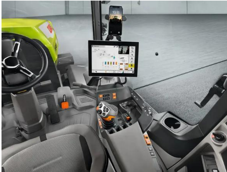
Рис. 15. Трактор CLAAS – підлокітник і багатфункціональний джойстик.
