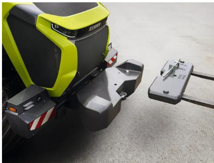
Рис. 8. Система підтримки СЕМОС – правильне баластування.
