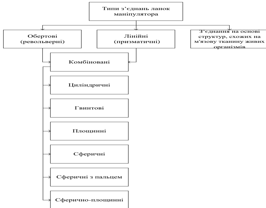
Рис. 8. Класифікація типів зєднань ланок маніпулятора
