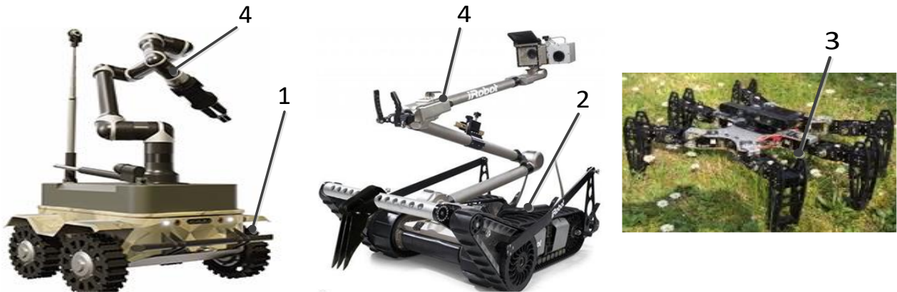
Рис. 4. БРП з 1-колісним; 2-гусеничним; 3-крокуючим рушіями та 4-маніпуляторами.
